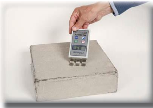
Mittaussyvyys 100 mm -mittaa betonilaatan kosteutta
