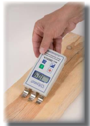
Mittaussyvyys 100 mm, - puupalkin kosteusvaurioiden paikallistaminen
