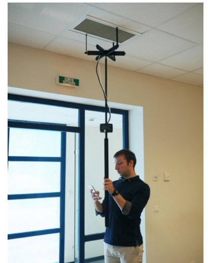
Käyttö mittausyksikön ja erillisen mittausristikon kanssa
