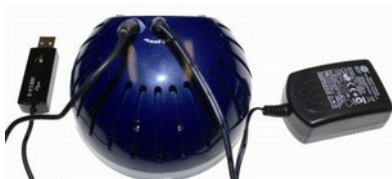
Kuva 5: Loggerin takaosa. USB kaapeli ja virtalähde kytkettyinä.
