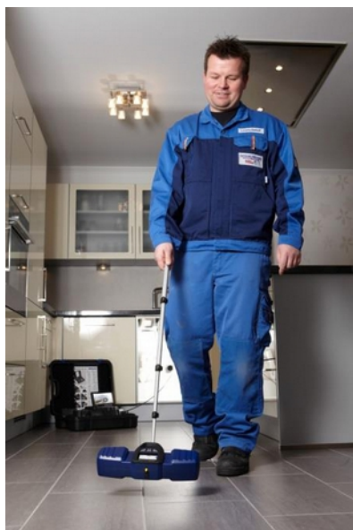
Kuva 6: Kamerapään paikannus lattian alta.
