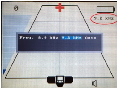
Kuva 4: Lähetystaajuusvaihtoehdot. Valittu taajuus näkyy näytön oikeassa yläkulmassa.
