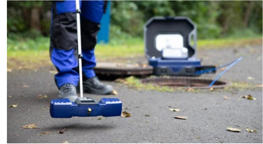
Wöhler L 200 paikantimella kamerapää voidaan paikantaa erittäin tarkasti.
