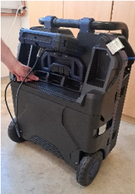
Kuva43 : Kela liitäntäkaapeli ennen kuin työnät näytön takaisin paikalleen.
