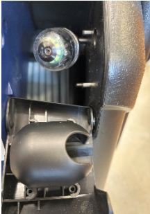
Kuva23 : Kuljetuslukko voidaan säilyttää kameran luukussa
