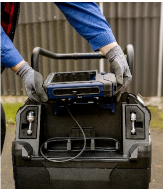
Kuva100 : Vedä näyttö ylöspäin irrottaaksesi sen ja jalustan pidikkeestä
