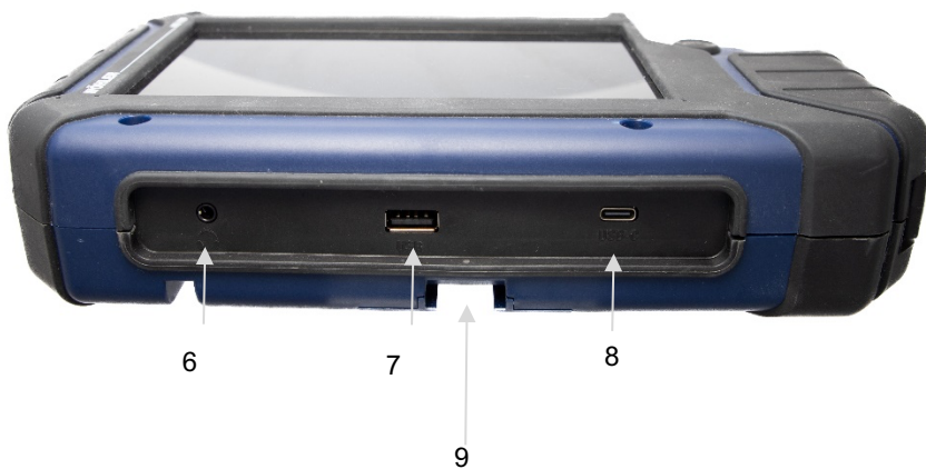
Kuva9 : Näytön alapuoli liitäntälevyllä
