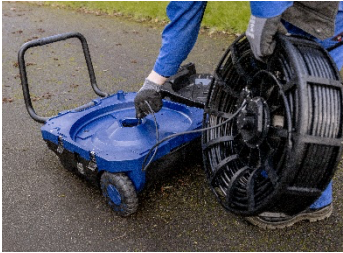
Kuva16 : Vedä liitäntäkaapeli kelanpitimen aukon läpi.
