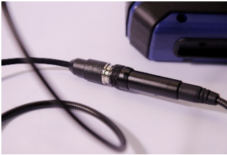
Kuva30 : Pyöreä liitin anturin liittä- näissä
