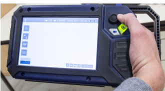
Kuva44 : Kun kahva on vedetty ulos, monitoria voidaan pitää ja käyttää yhdellä kädellä.
