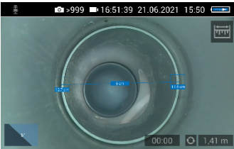
Kuva78 : Kahden mittauspisteen välisen etäisyyden näyttö
