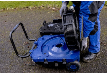
Kuva110 : Aseta kela kelanpitimelle
