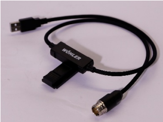
Kuva27 : Adapteri Wöhler VE-antureille
