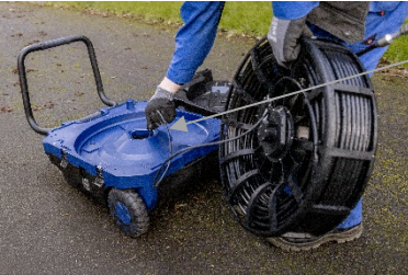
Kuva109 : Vedä liitäntäkaapeli kelanpitimen aukon läpi
